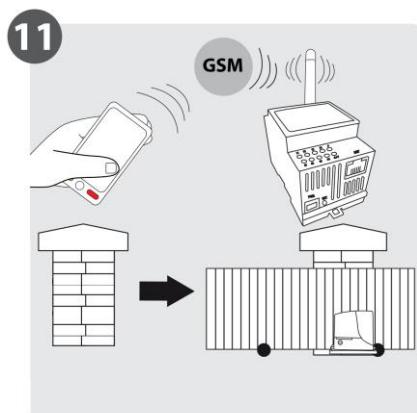
GSM Klíč je zařízení, které Vám umožní otevírat vrata, bránu a další zařízení prozvoněním z telefonu. Uživatelé jsou autorizováni na základě telefonního čísla příchozího hovoru. Seznam oprávněných uživatelů může administrátor upravovat pomocí SMS zpráv nebo z PC. Jelikož příchozí hovor není uskutečněn, je otevření brány bezplatné.
